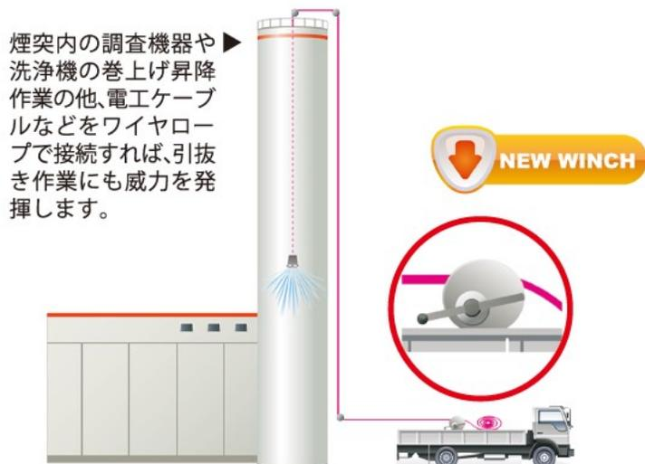
煙突内の調査機器や洗浄機の巻上げ昇降作業の他、電工ケーブルなどをワイヤロープで接続すれば、引抜き作業にも威力を発揮します。
