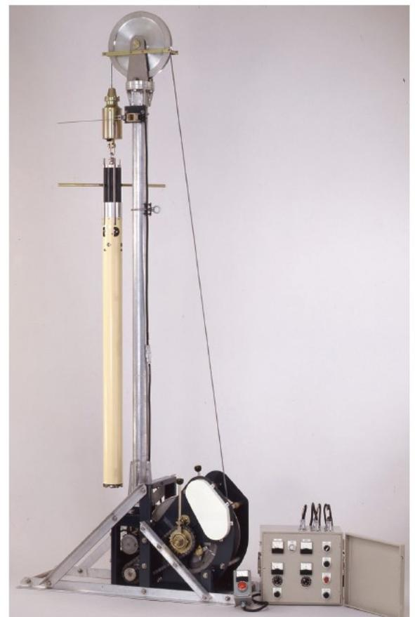
南極観測用「氷床浅層掘削装置」
