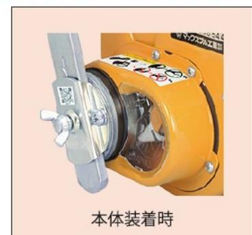
SI 同様、ブレーキを解除してドラムを空転させるストッパアームがなく、密閉式の⑩クラッチカバーにストッパ機構全体を内蔵したタイプです。ブレーキ機構全体を防塵、防滴仕様とするため、⑩クラッチカバーの取付けフランジ面に「シールドパッキン」を、⑫クラッチとの摺動部に「シールドリング」を、それぞれ使用し、密閉性を向上させました。外部からの異物混入が減るため、ブレーキ部分のメンテナンス期間も他機種に比べ、比較的長い傾向です。また、密閉性が防音効果を生み、ブレーキ機構から発する騒音も小さく抑えています。
