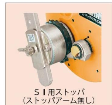
主に不特定多数の人が使う現場 (学校体育用で使われる各種ネットの昇降、バスケット・ゴールボードの昇降、舞台装置の昇降など) の使用に適しています。ブレーキを解除してドラムを空転にできるストッパアームをなくし、ストッパ機構を密閉式の⑩クラッチカバーに内蔵した方式で、巻上げ・巻下げ作業中や保持中に「ストッパを外す」という誤操作を防止し、間違いなく安全に作業することができます。
