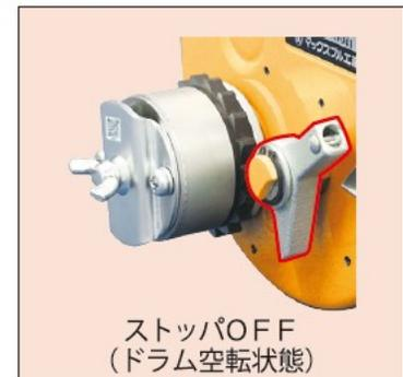
無負荷時にストッパの噛み合いを外すことにより、ブレーキを解除することができるタイプです。ドラムを空転状態にすることが可能なので、ハンドルを取外してから、ドラムに巻いてあるワイヤロープを引くと、簡単に引き出せます。普段、ワイヤロープをドラムに収納してあって、作業時のみワイヤロープを引き出して使うときに便利です。ご注文の際は、たとえば GM-5、ESB-5 というようにご用命ください。
